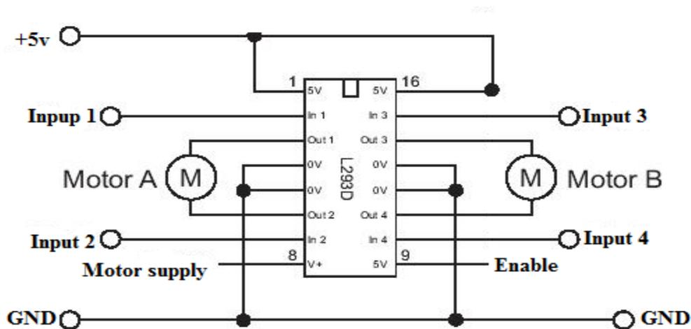
Figure 4.16 L293D Motor Driver Ckt.
