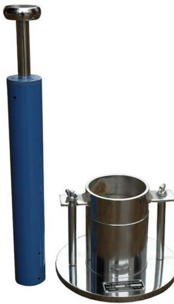
Fig 3.4.1: Modified Proctor test apparatus
